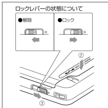
1. 電池カバーのツメを本体の内側に入れ、本体と電池カバーの間にすき間が生じないように①の方向に押さえながら、電池カバーを閉じます。
