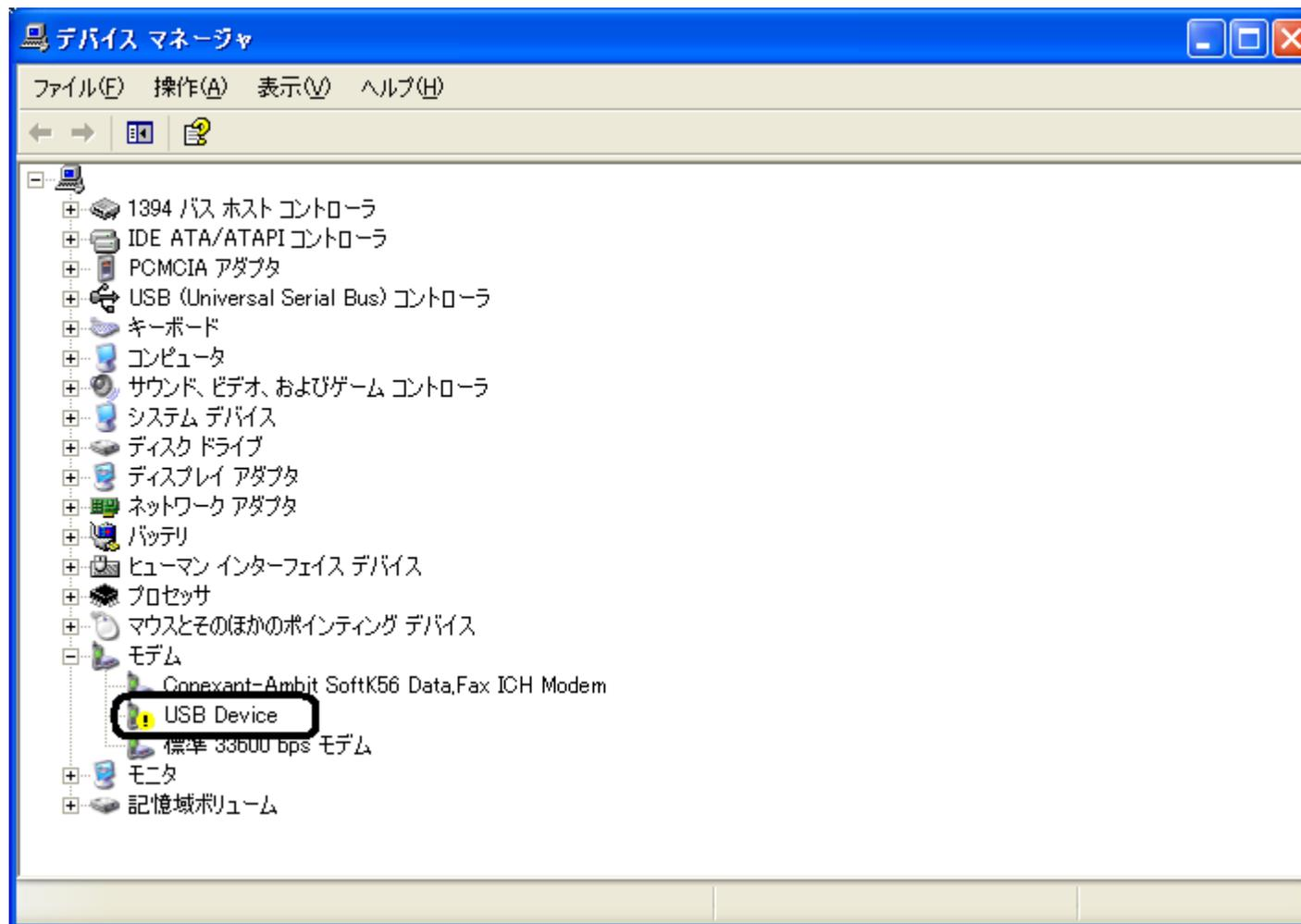
2. !マークが表示されている「USB Device」を右クリックし、「削除」を選択します。
