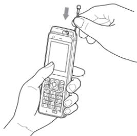
アンテナを収納するときは、アンテナの根元を持ってまっすぐに下ろしてください。
