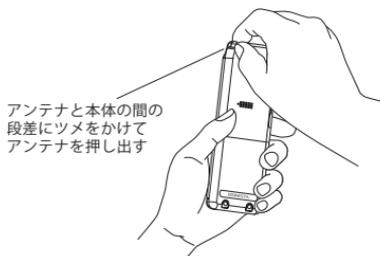
アンテナと本体の間の段差にツメをかけてアンテナを押し出す
